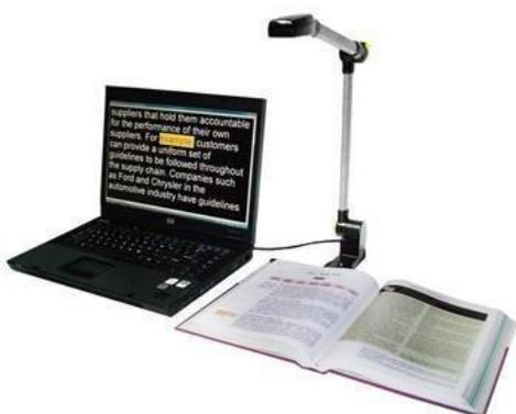
Возможности нового оборудования ЭРВУ Сокол позволяют не только увеличивать тексты в печатном виде, он также выполняет функцию читающей машины. ЭРВУ сканирует текст и воспроизводит его через динамик или наушники. Встроенный дисплей имеет размер 4,3 дюйма, предназначенный для слабовидящих людей с остротой зрения 0,03-0,1. Громкость воспроизведения регулируется от 0 до 14 значений.
