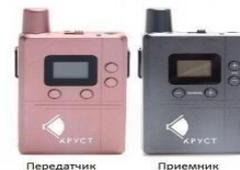
Радиокласс работает в стандартном диапазоне 863-865 Mhz и позволяет педагогу предварительно настроить все устройства на один из 18 возможных каналов, что даст возможность проводить обучение, и создавать несколько радиоклассов внутри одного здания, и настраивать каждому индивидуальную частоту.
