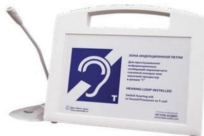
Прослушивание аудиоинформации лицом с нарушенной функцией слуха производится через слуховой аппарат в режиме индукционной катушки «Т». Переносная система преобразует акустический сигнал (речь оператора) или электрический аудиосигнал (сигнал громкой связи) в электромагнитный, который принимается индукционной катушкой слухового аппарата.
